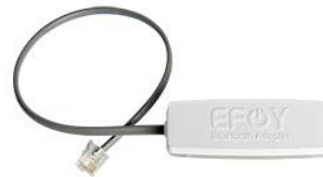
Bluetooth Adapter ( optional ): Über die EFOY App können wichtige Informationen abgerufen werden. Funktioniert nur an der RS232- Schnittstelle (rechte Buchse)
